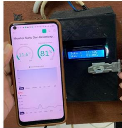
Gambar 8. Tampilan pembacaan data sensor pada app Blynk dan hardware (LCD)
